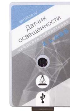
Рисунок 4.3.1. Датчик освещенности
