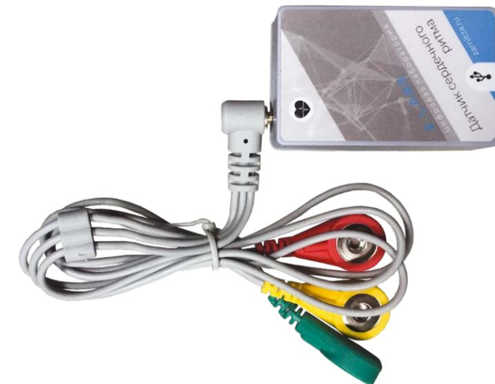
Рисунок 4.9.1. Датчик-электрокардиограф
